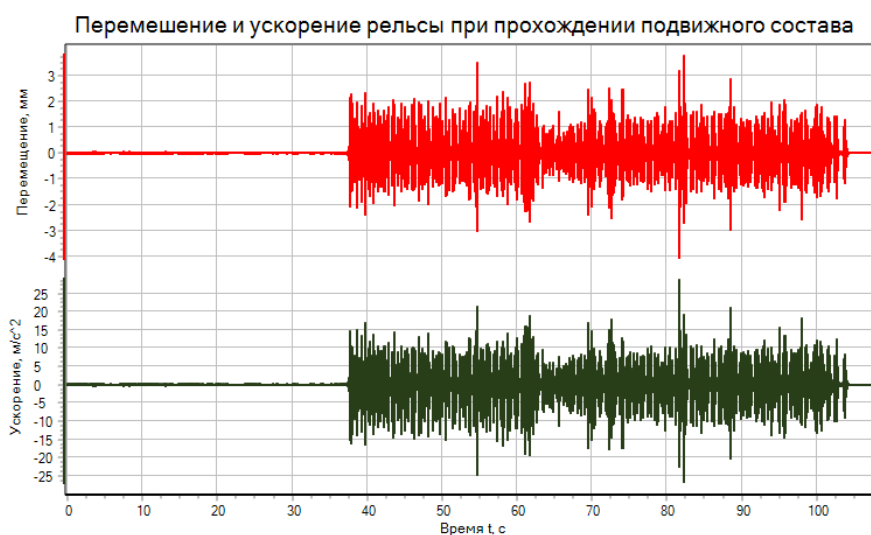
Рисунок 4 – Горизонтальное перемещение и ускорение правого рельса
