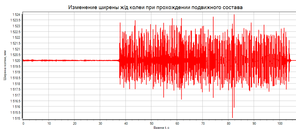
Рисунок 5 – Динамические изменения ширины железнодорожной рельсовой колеи под воздействием подвижного состава
