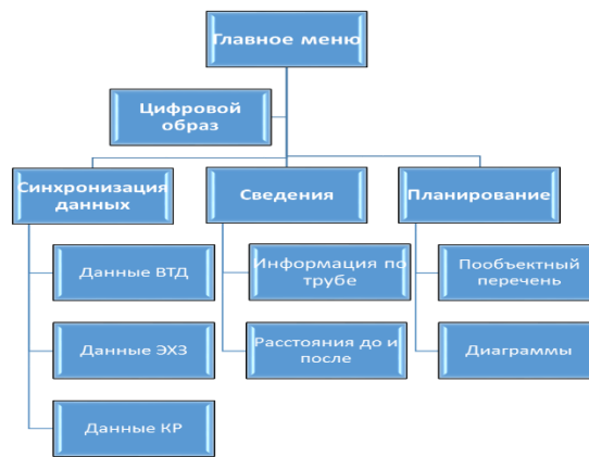
Рисунок 3 – Схема логических связей между модулями программы «Цифровой образ линейной части»
